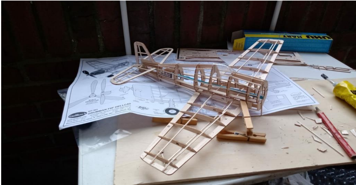
De bouw van de Grumman 6F6 Hellcat. Met een "rubber motor". Een propeller verbonden met een elastiek.
